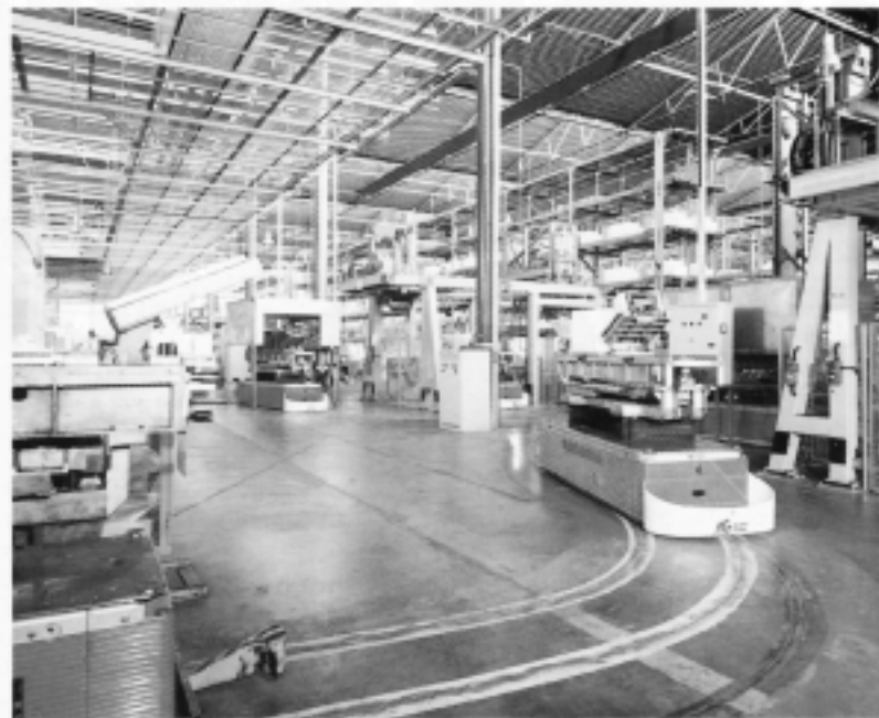
Carrelli filoguidati AGV in area montaggio mobili.
